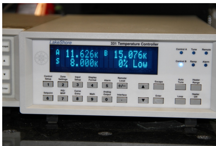
Figura 16. Equipamento eletrônico (voltímetro digital) para monitoramento da temperatura; observe que o painel do equipamento está marcando a temperatura de 8K (-265°C).
