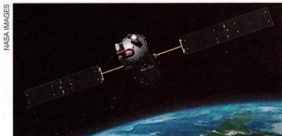
Representação do satélite Orbiting Carbon Observatory , destinado a medir a presença de carbono na atmosfera terrestre. (2007)
