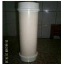
Figura 17: tubo de PVC 100 mm com cap.
