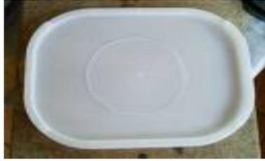
Figura 23: Tapa do pote de sorvete de 2 litros, usada como moldura para a folha de alumínio.
