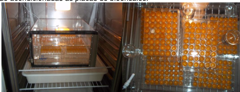
Figura 8. Interior da estufa B.O.D. Eletrolab, com a caixa hermética no interior da qual são acondicionadas as placas de bioensaios.
