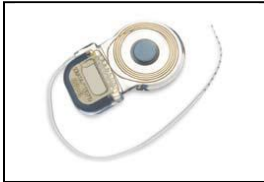
Figura 1 - Componente interno do sistema de implante coclear da Medical Electronics , modelo SONATA T1 100 . Fonte: http://www.medel.com/data/downloads/MAESTRO_US/Parent_Guide.pdf
