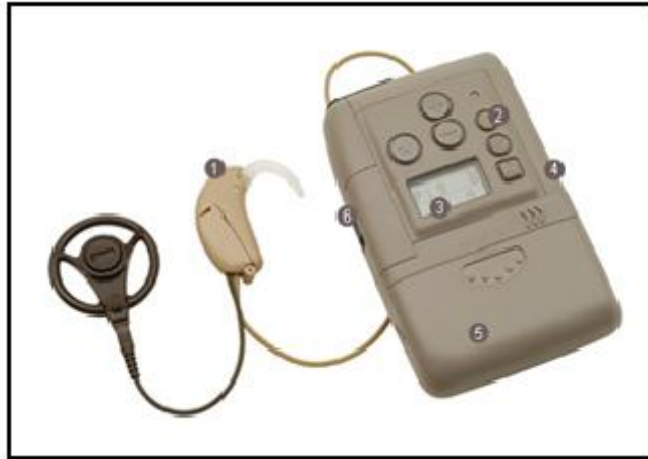
Figura 3 - Processador de fala em forma de caixa SPrint™, cabos e antena do sistema de implante coclear da Cochlear™. Fonte: http://www.cochlear.com/sea/sprint
