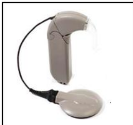
Figura 2 - Processador de fala retroauricular OPUS 2, cabo e antena externa do sistema de implante coclear da Medical Electronics . Fonte: http://www.medel.com/data/downloads/MAESTRO_US/Parent_Guide.pdf
