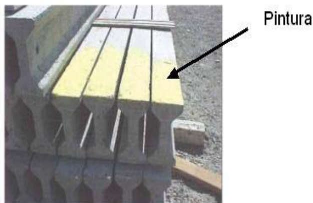
Figura 2.9 Utilização da Poka-Yoke em terça pré-fabricada
