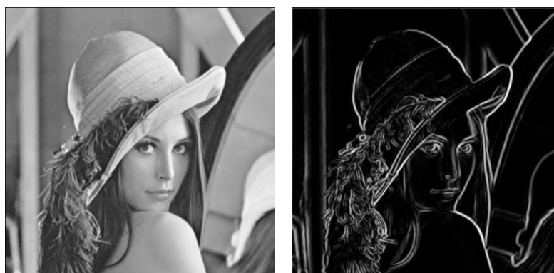
Figura 3.6: Detecção de descontinuidades na imagem Lena utilizando uma função de interação adaptativa
