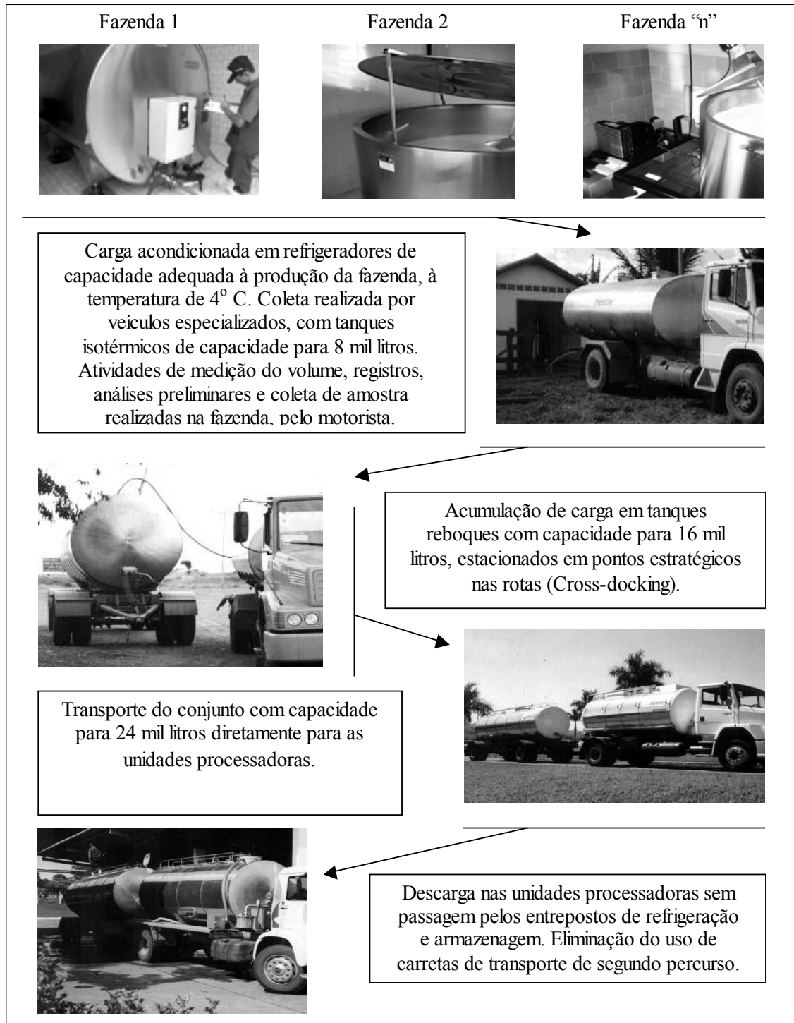
FIGURA 4.2 – O processo de coleta a granel.
