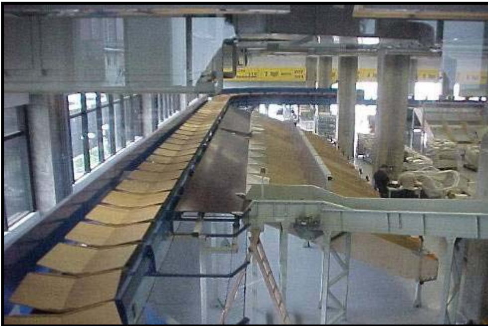
Figura 3.18: Bandejas basculantes (à esquerda) e Deslizadores (à direita). (CTE Saúde, 2003).
