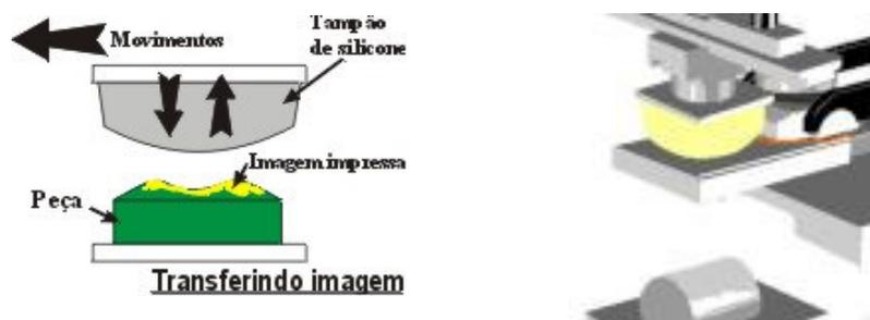
Figura 5.4. Diagrama esquemático do processo de tampografia.
