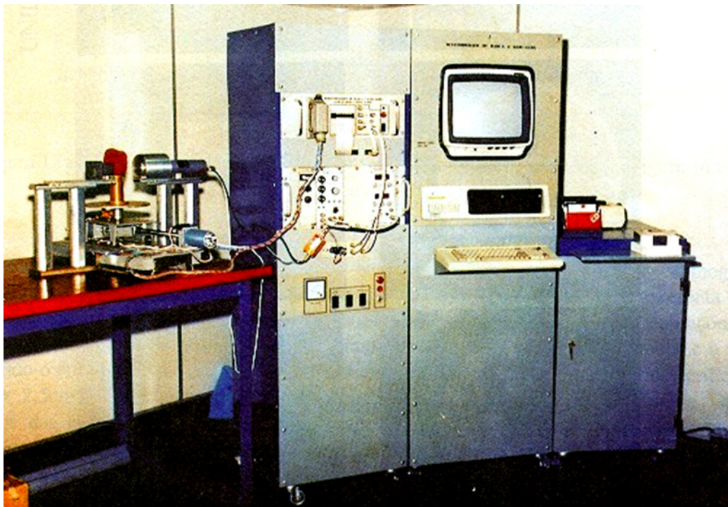
Figura 1. Mini-tomógrafo da Embrapa Instrumentação Agropecuária (CRUVINEL 1987).
