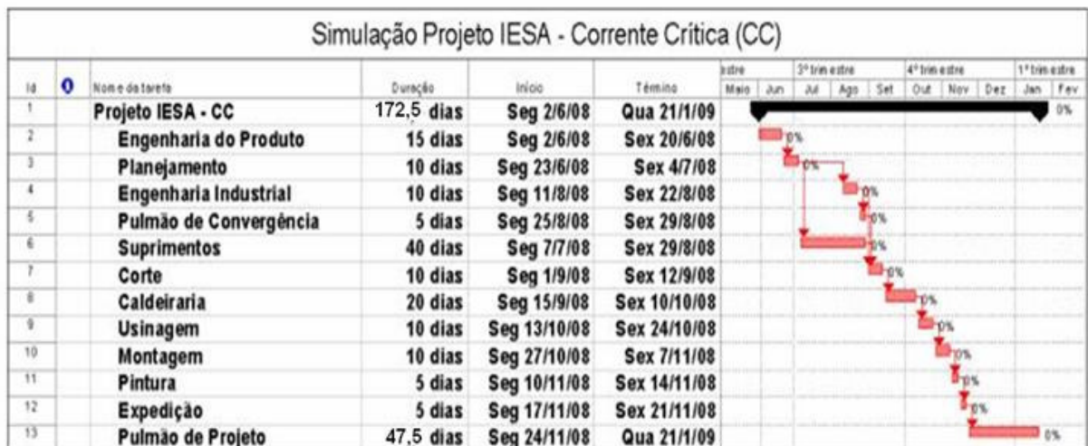
Figura 6.8: Rede de atividades utilizada na empresa, com aplicação do método da Corrente Crítica.
