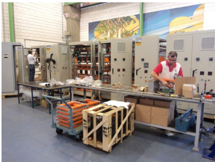
Figura 17: Montagem de Filtros de Harmônicos
