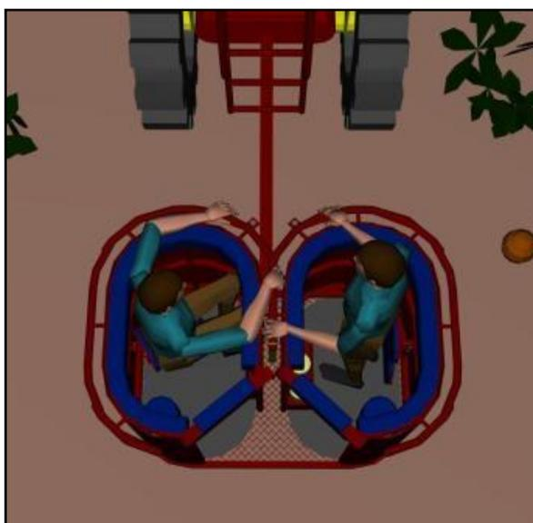
Figura 33: Ilustração de novo conceito de Plataforma de Inspeção com vista superior do piso inferior. Nesta foto, retirou-se a capota para melhor visualização dos detalhes.
