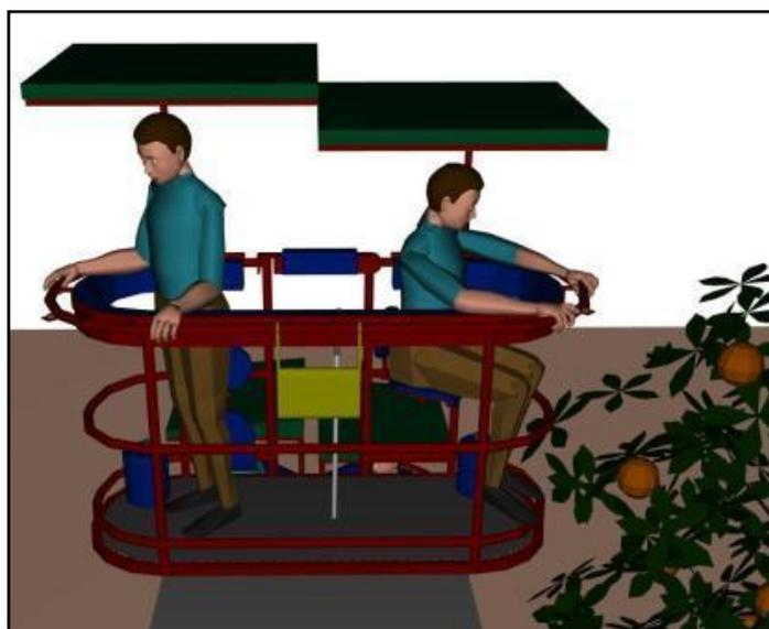
Figura 35: Ilustração de novo conceito de Plataforma de Inspeção com destaque para piso superior. Foi retirada a lateral de metal da ilustração para melhor visualização de detalhes.
