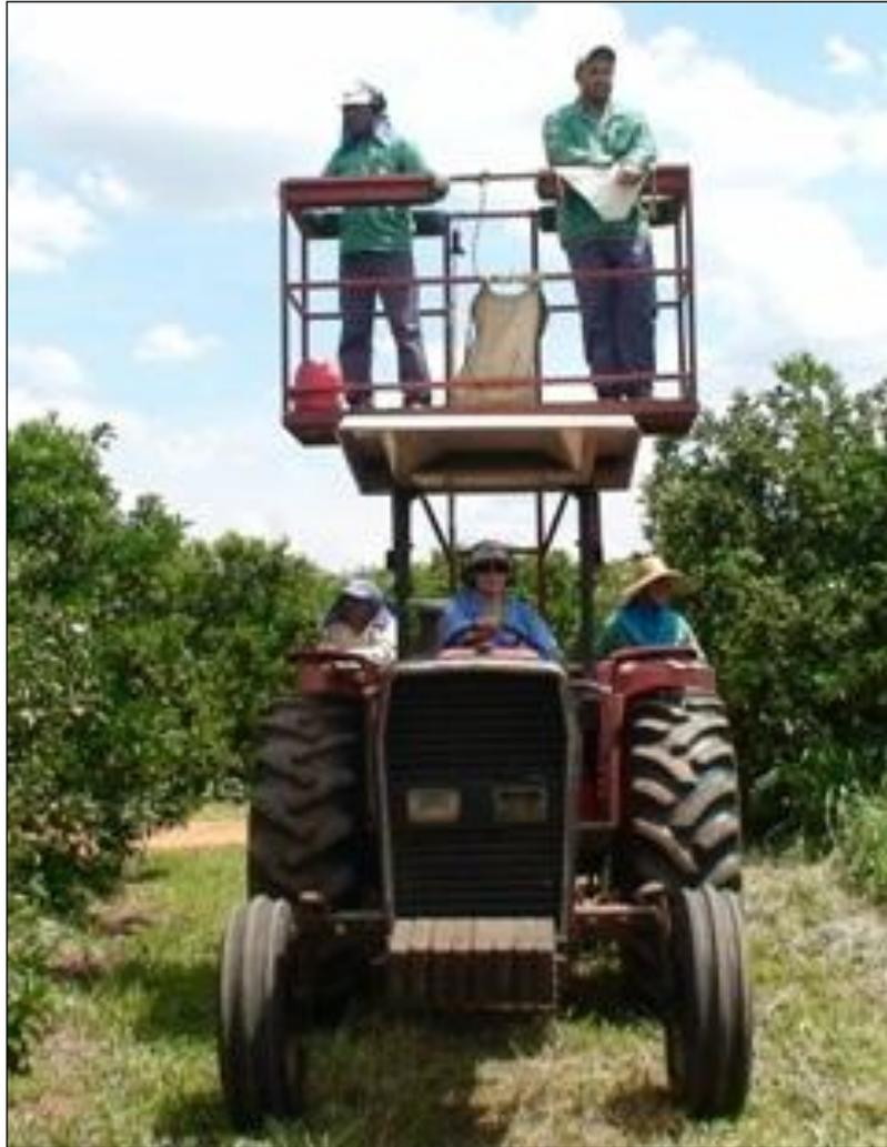
Figura 14: Exemplo de plataforma dupla de inspeção.
