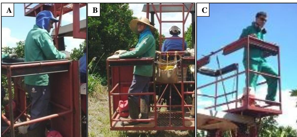
Figura 21: Posicionamento dos inspetores na plataforma. A: inspetor com os braços apoiados na borda frontal da plataforma. B: inspetor com apoio do peso do corpo concentrado em uma das pernas. C: inspetor com apoio de um dos pés sobre a estrutura da plataforma.
