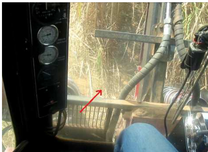
Figura 14. Análise da altura de corte de base de dentro da cabine (em destaque: touceira deixada após o corte)
