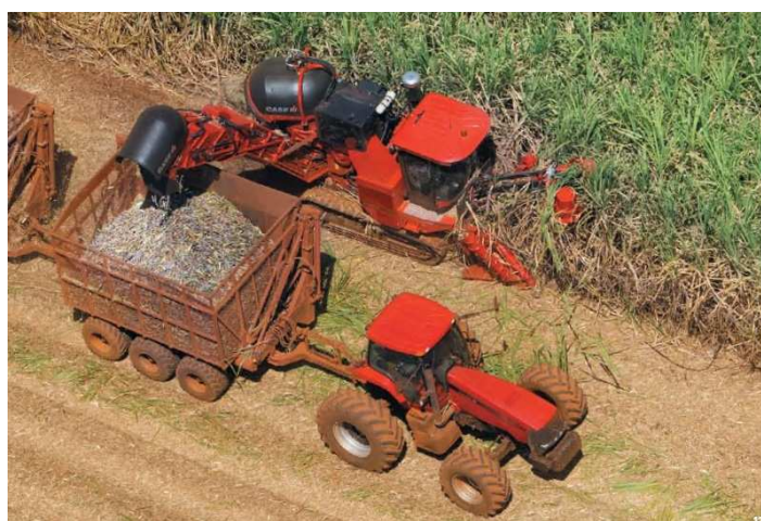
Figura 16. Deslocamento simultâneo da máquina colhedora e trator com transbordo (Fonte: CASE, 2009)
