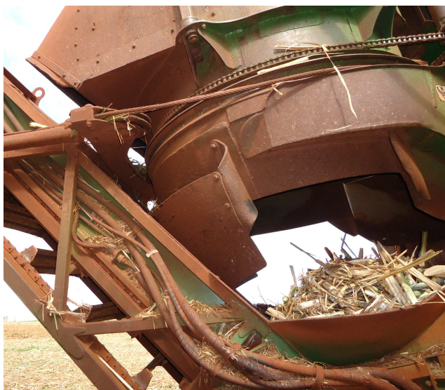
Figura 15. Acúmulo de rebolos de cana no cesto do elevador
