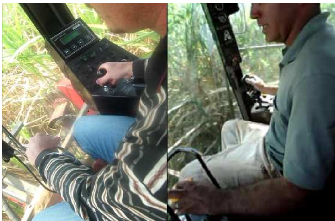
Figura 20. Manches de acionamento das esteiras das máquinas CASE 7700 (à esquerda) e John Deere 3510 (à direita)
