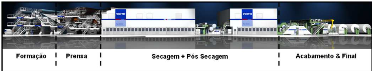
Figura 6.5 - Máquina de Papel e suas Seções
