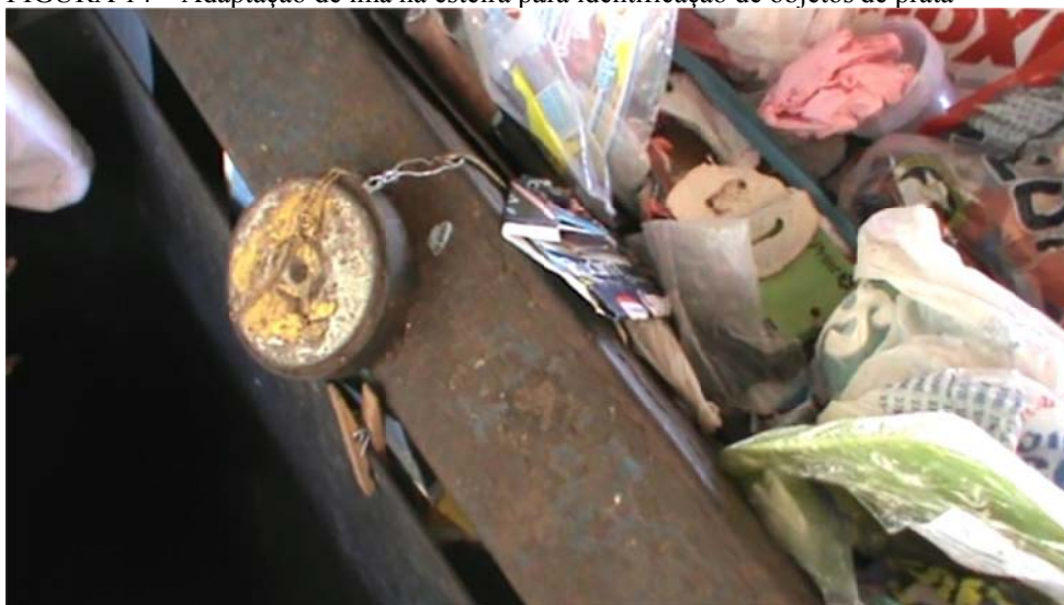
FIGURA 14 – Adaptação de imã na esteira para identificação de objetos de prata
