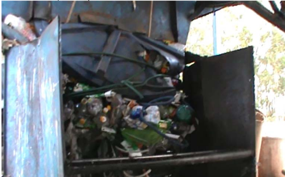
FIGURA 13 – Caçamba emperrada devido ao excesso de materiais
