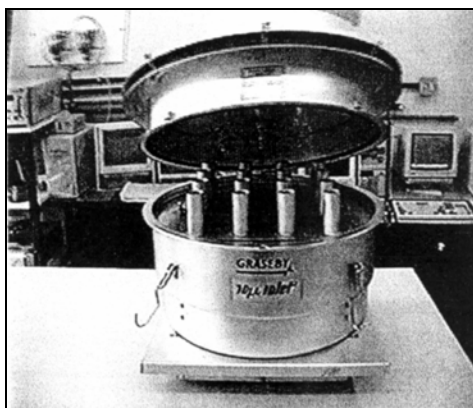
Figura 3.4: Detalhe da Câmera de impactação inercial
