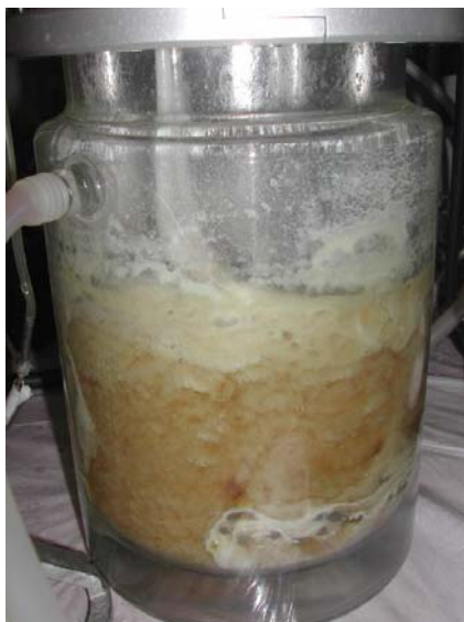
Figura 5.40: Cultivo de Penicillium chrysogenum em biorreator no modo batelada utilizando concentração inicial de sacarose de 25 g/L e 100 mL de inóculo.
