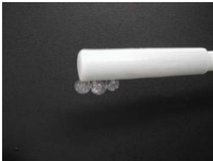
Figura 5.35 PGA immobilizada dispersa em agarose dissolvida a 85 °C contendo partículas magnéticas.
