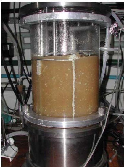
Figura 5.41: Cultivo de Penicillium chrysogenum em bioreator no modo batelada utilizando concentração inicial de sacarose de 25 g/L e 10 mL de inóculo.
