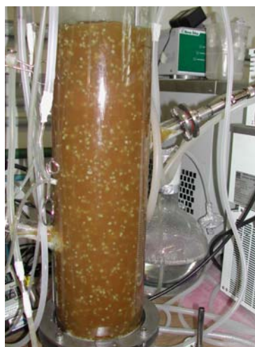
Figura 5.56: Crescimento de P. chrysogenum em air lift após quatro dias de cultivo.
