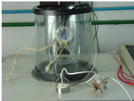
Figura 3.7: Fotografia da tampa da câmara de secagem com a abertura central.
