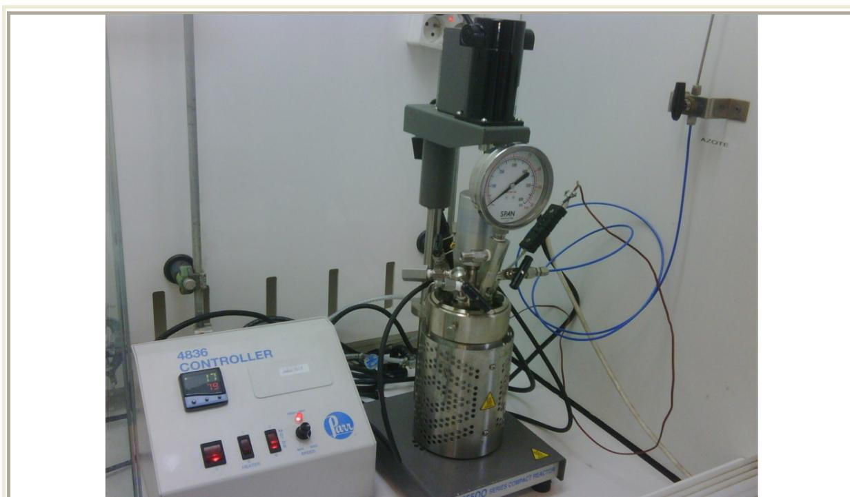
**Figura 3.6.** Reator utilizado na transesterificação de óleos vegetais.
