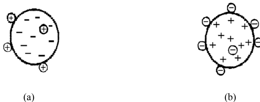
Figura 2.5: (a) Esquema de um trocador catiônico; (b) Esquema de um trocador aniônico (Collins et al., 1995).
