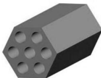
Figura 12 - Estrutura de poros hexagonal, MCM-41, SBA-15 e HMS
