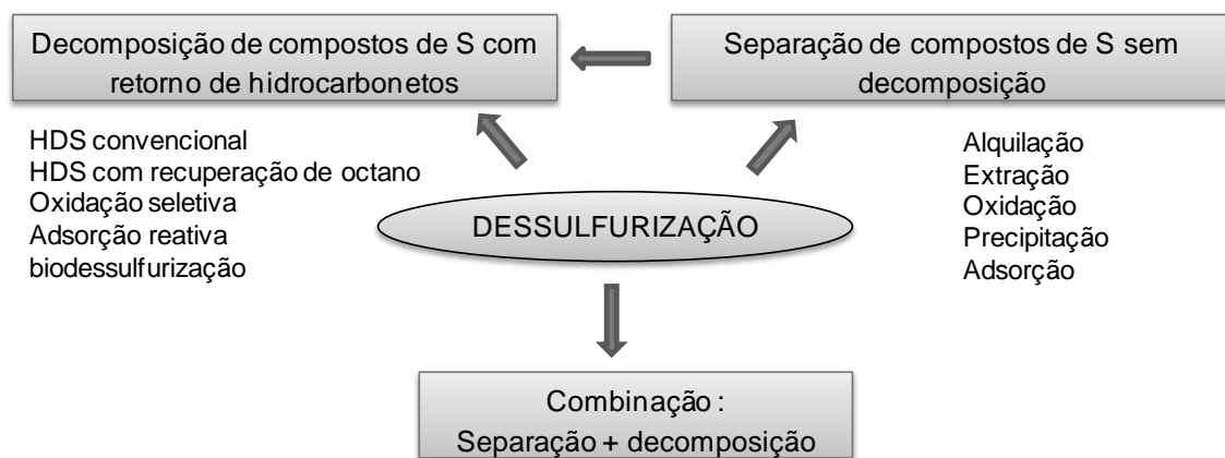
Figura 1 - Classificação dos processos de dessulfurização baseada na transformação dos compostos orgânicos de enxofre.
