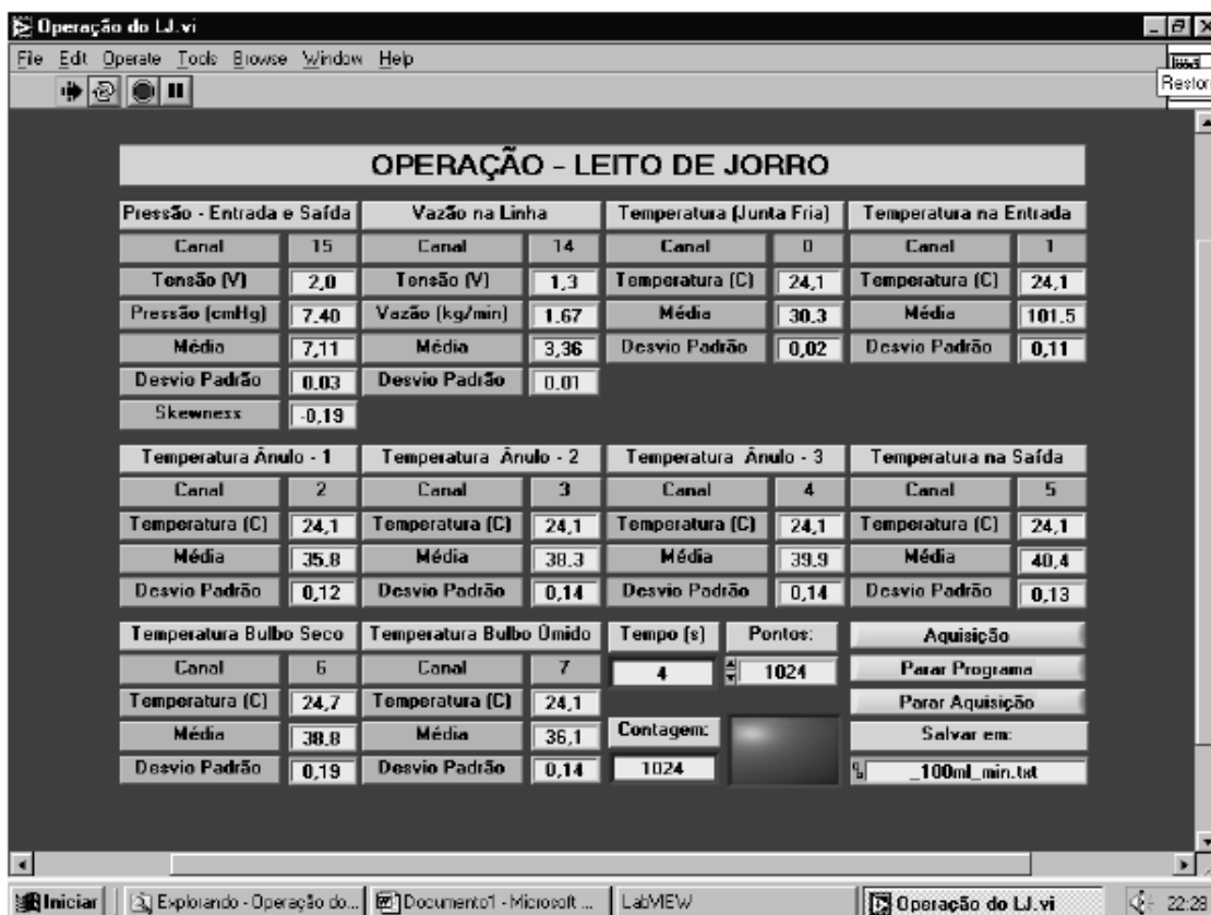
Figura 3.5: Rotina em modo LabVIEW criada para a secagem no leito de jorro.
