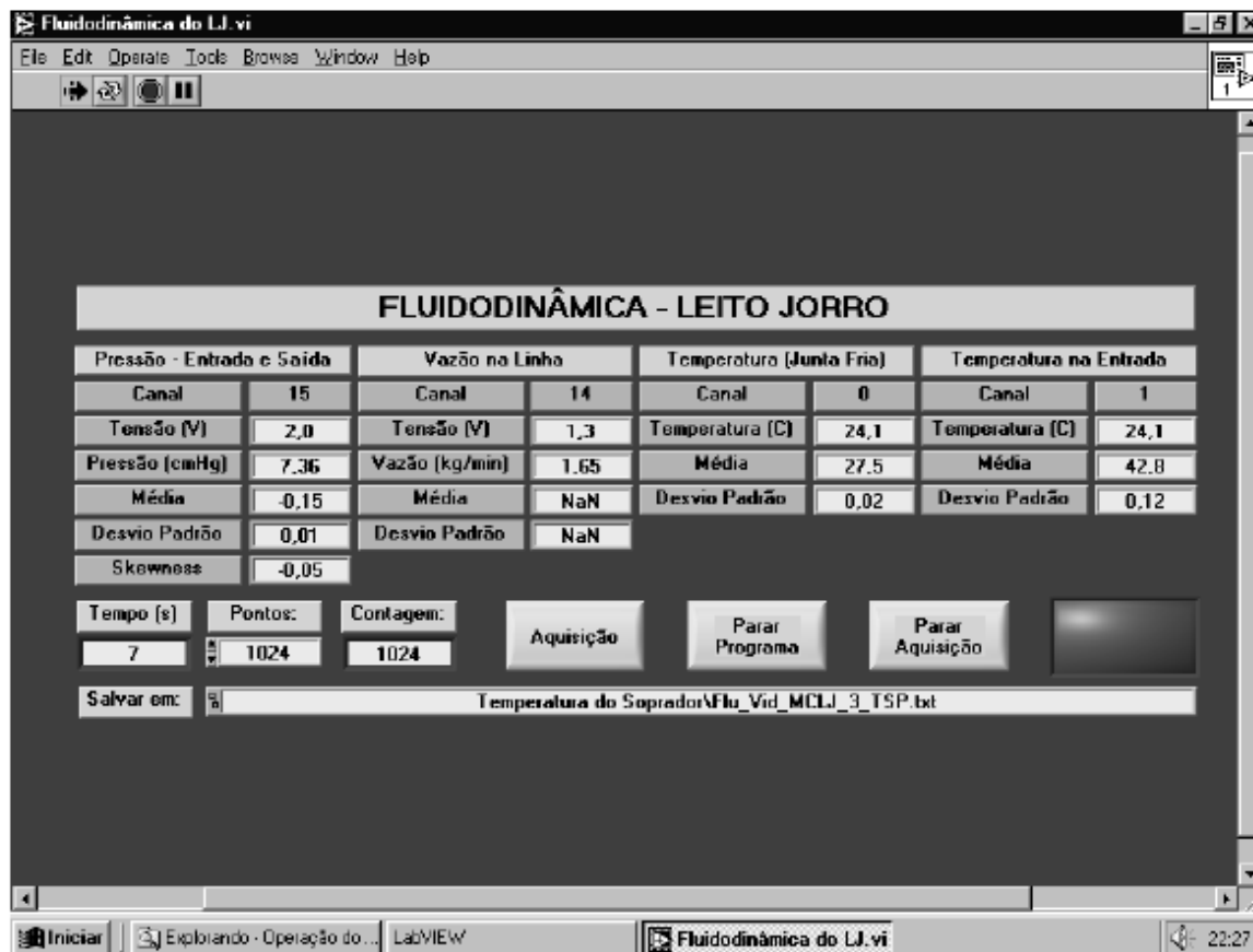
Figura 3.4: Rotina em modo LabVIEW criada para a fluidodinâmica.
