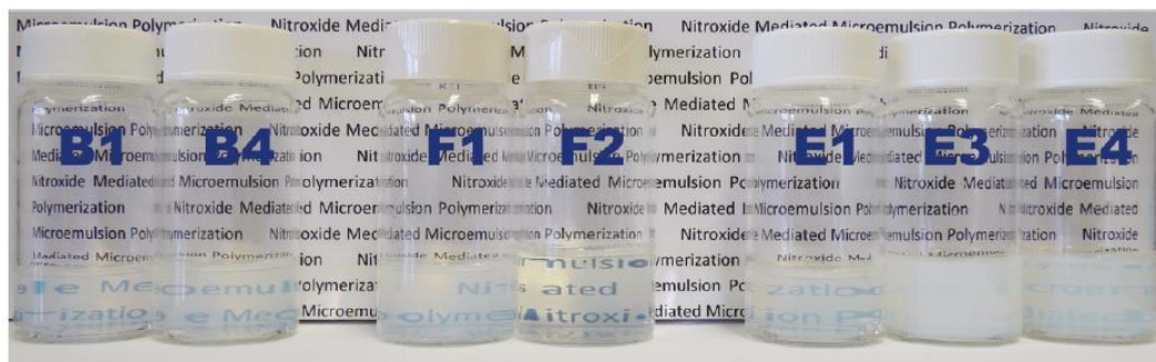
Figura 3.23: Exemplo de dispersão após a polimerização em emulsão (THOMSON et al. 2011)
