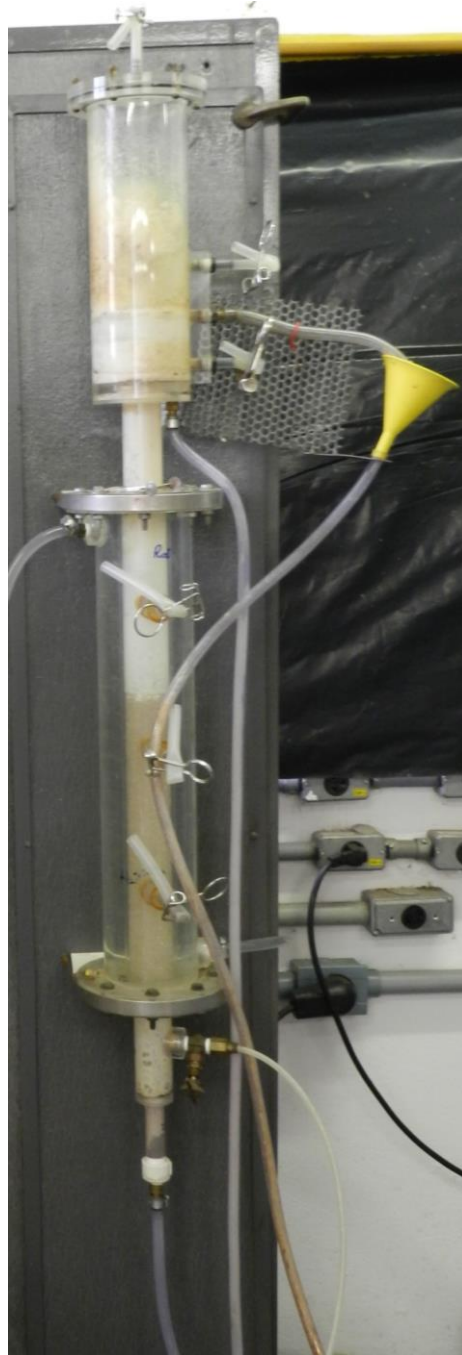
Figura 3.2 – Reator anaeróbio de leito fluidizado.
