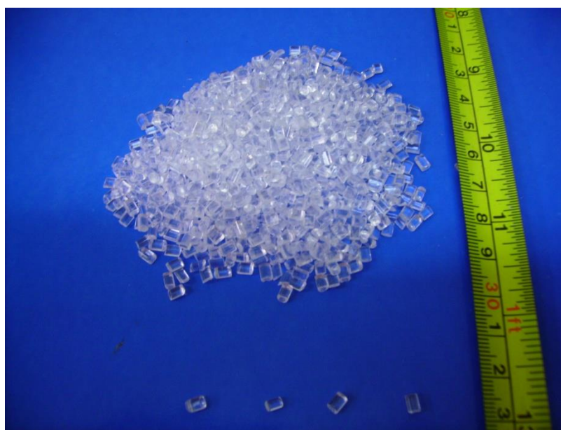
Figura 3.4 – Partículas de poliestireno com tratamento para utilização como suporte para imobilização da biomassa.
