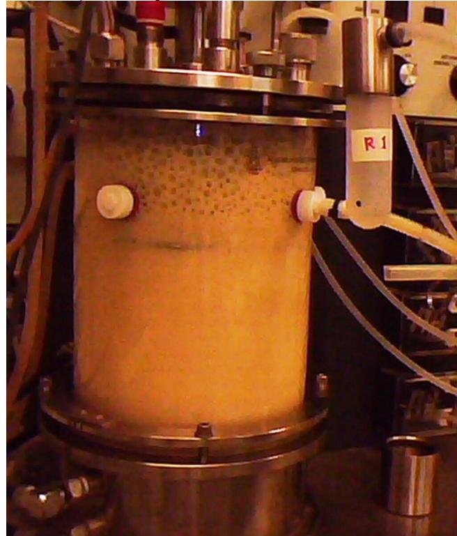
Figura 5.39. Imagem do caldo de cultivo com o impelidor TR em 10 horas de cultivo, com destaque para a grande formação de espuma.
