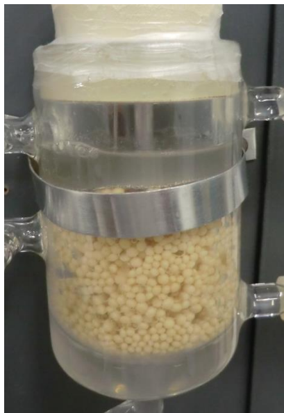
Figura 4.23 – Imagem do reator contínuo contendo bicatalisador IGI-Ch/S. cerevisiae (20:10) após 11 dias de ensaio.
