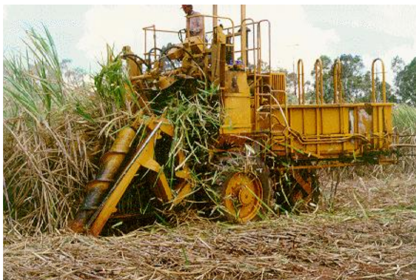
Figura 2. 7 - Cortadora COPERSUCAR em Teste de Campo (NEVES, 2003).
