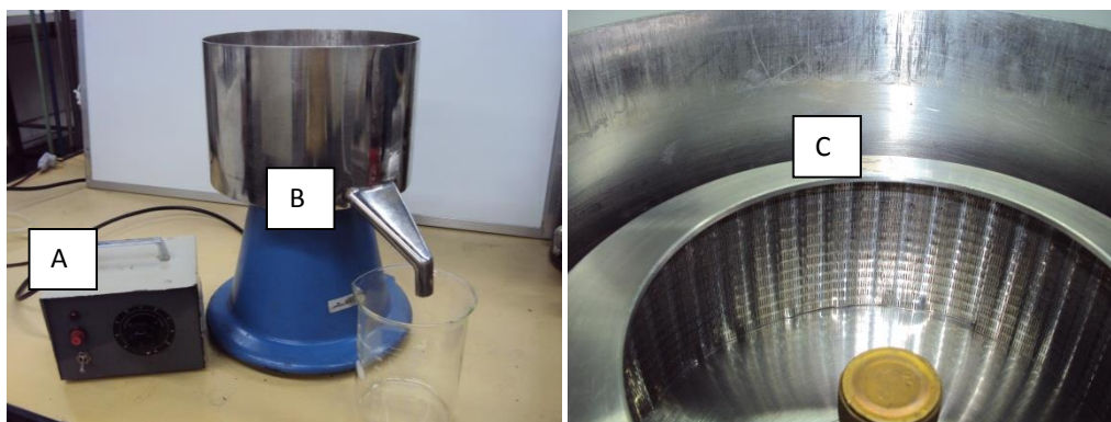
Figura 3. 5 - Centrífuga de laboratório tipo cesto, marca Metalúrgica Sueg Ltda: (A) controlador da centrífuga, (B) centrífuga e (C) cesto.
