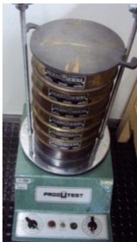
Figura 3. 11 - Equipamento utilizado no peneiramento das amostras de açúcar (Produtest).
