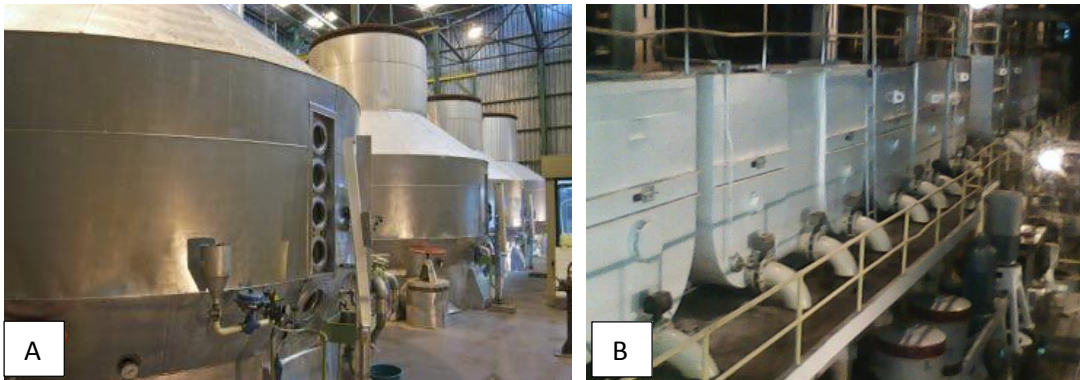
Figura 2. 19 - Sistema de cristalização por evaporação a vácuo: (A) Cozedores e (B) Cristalizadores horizontais.
