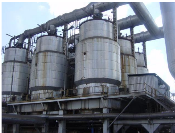
Figura 2. 17 - Sistema de pré-evaporadores e evaporadores.
