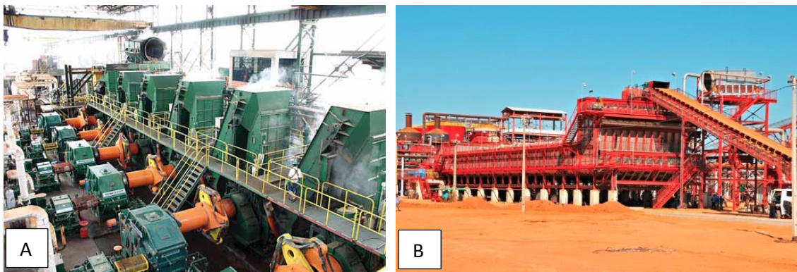
Figura 2. 13 - Sistema de extração de caldo de cana: (A) Moenda e (B) Difusor.
