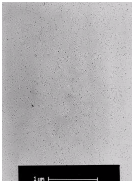
Figura J.4 – Partículas de NaCl geradas com solução de 1 g/l e aumento igual a 13k.
