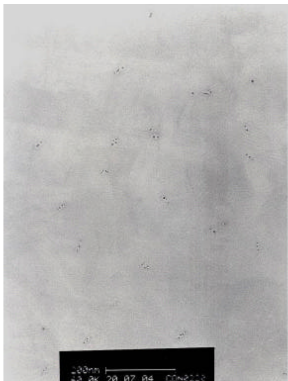
Figura J.14 – Partículas obtidas com a solução salina de concentração igual a 0,5 g/l.
