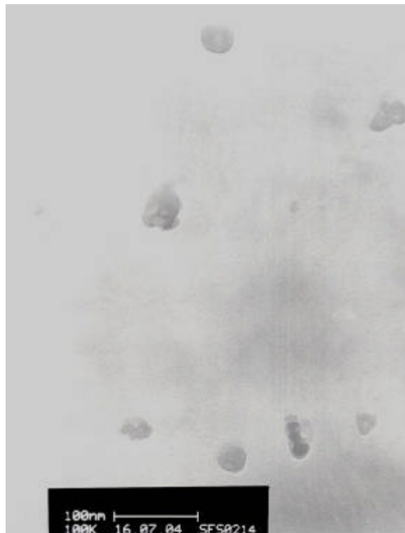
Figura J.16 – Partículas obtidas com a solução salina de concentração igual a 1,5 g/l.
