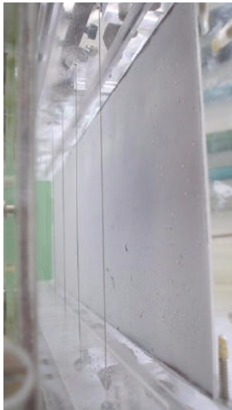
Figura 4.10 - Saída do precipitador com L_{ne} = 0,30 cm.
