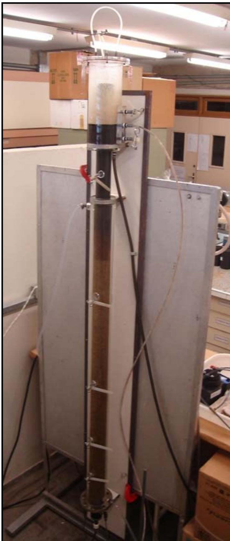
Figura 3.4 – Reator anaeróbio de leito fluidizado.
