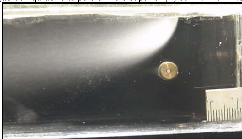
Figura F8-Injeção de líquido feita pelo orifício superior (1) com V = 74 m/s e Q = 0,6 l/min
