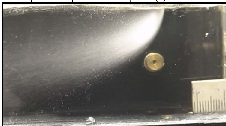
Figura F3-Injeção de líquido feita pelo orifício superior (1) com V = 59 m/s e Q = 0,5 l/min
