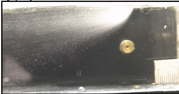
Figura F1-Injeção de líquido feita pelo orifício superior (1) com V = 59 m/s e Q = 0,3 l/min
