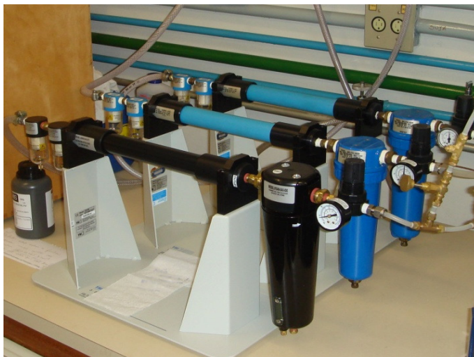
Figura 3.2 – Foto dos filtros de purificação de ar.
