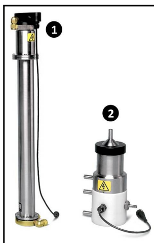
Figura 3.13 – Analisador de Mobilidade Diferencial: (1) Long-DMA e (2) Nano-DMA.
