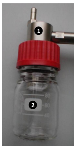
Figura 3.6 – Sistema de geração de partículas: (1) atomizador com saída para o aerossol e (2) porta-solução de vidro.
