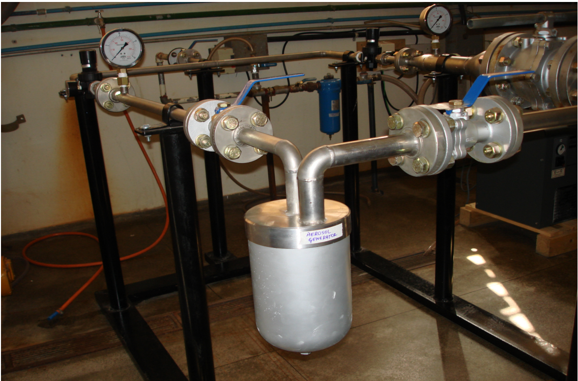
Figura 3.6: Aspersor de pó no tramo secundário
