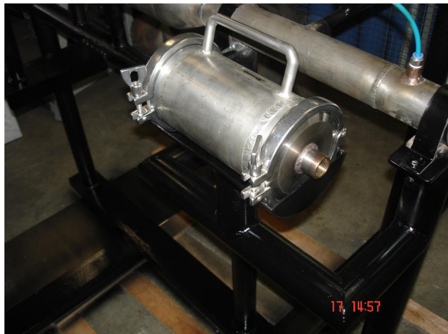
Figura 3.27: Sistema de limpeza dos meios filtrantes
