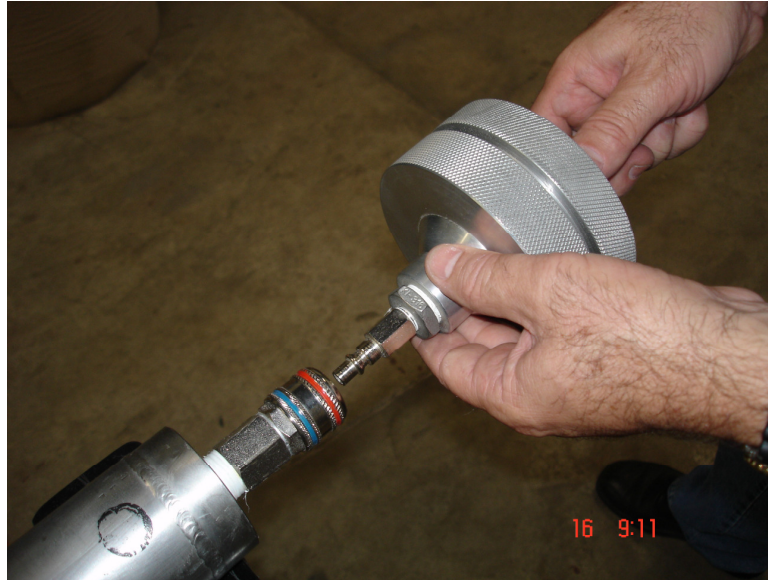
Figura 3.10: Montagem do filtro absoluto
