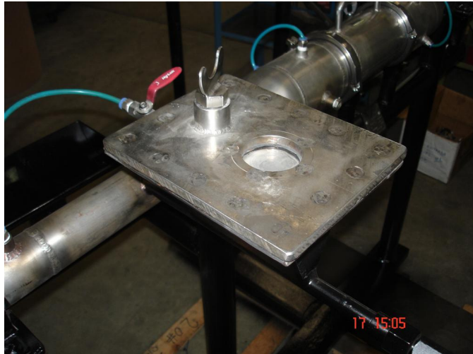
Figura 3.21: Sistema de alimentação de partículas com a abertura rápida, o visor de acrílico e a mangueira de pressurização do sistema
