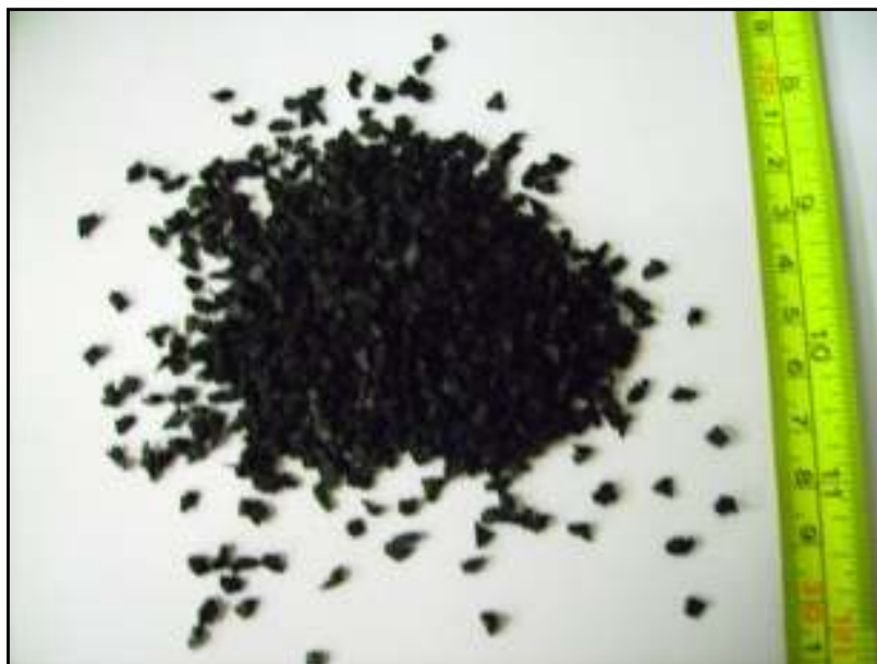
Figura 4.7 – Partículas de pneu triturado para utilização como suporte para imobilização da biomassa.
