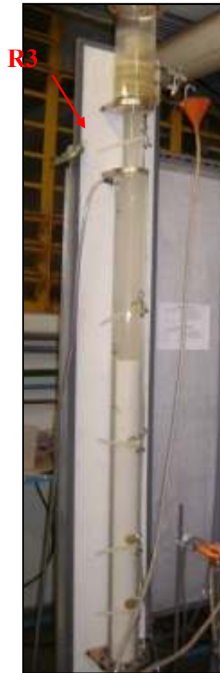
Figura 4.3 – Reator anaeróbio de leito fluidizado contendo PET (R3).
