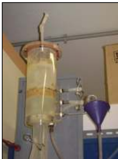
Figura 4.4 - Topo do reator (Câmara de captação de gás e dispositivo para saída do efluente).
