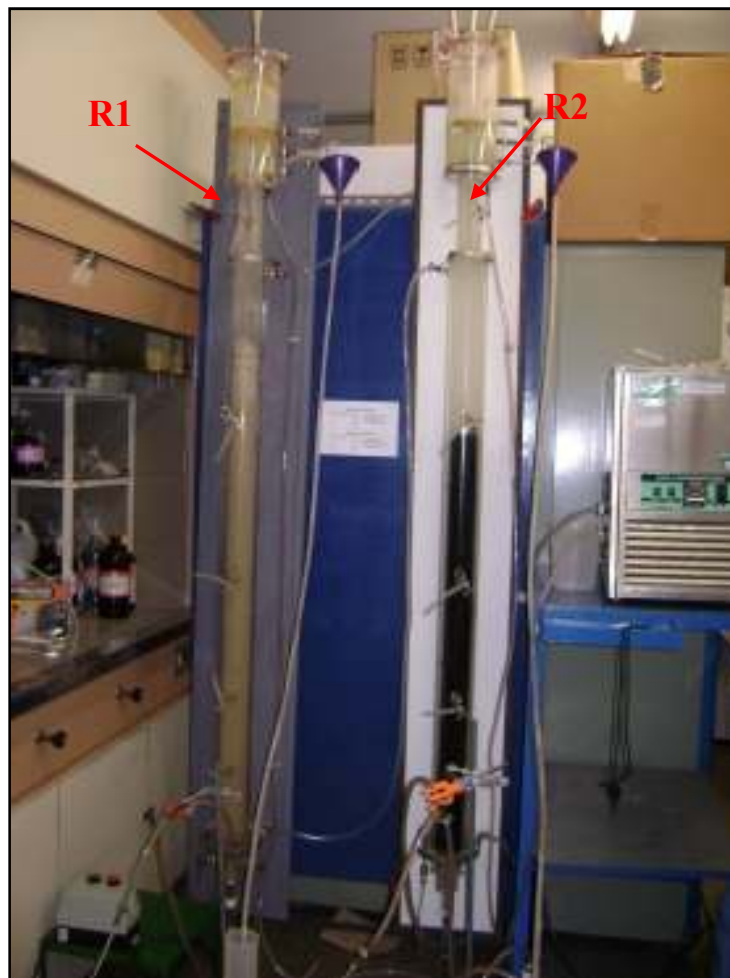
Figura 4.2 – Reatores anaeróbios de leito fluidizado contendo poliestireno (R1) e pneu (R2).
