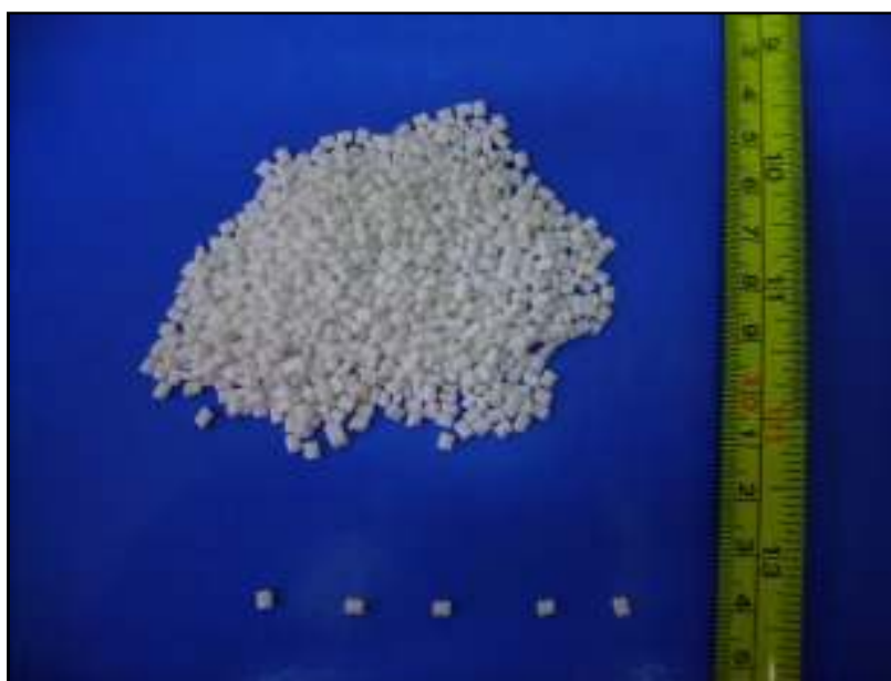
Figura 4.8 – Partículas de PET para utilização como suporte para imobilização da biomassa.
