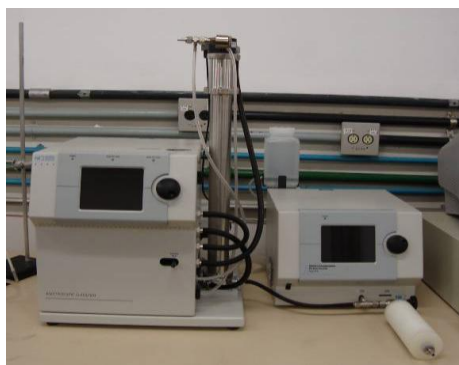
Figura 3.9 – SMPS: Classificador Eletrostático (à direita) e Contador de Partículas Ultrafinas (à esquerda).
