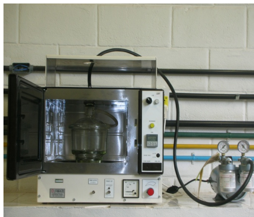
Figura 3.1: Equipamento adaptado para a secagem em microondas a vácuo.
