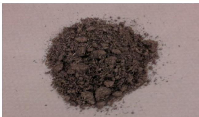
Figura 14. Fotografia ilustrando amostra de bagaço explodido não lavado. Condições de pré-tratamento: explosão a vapor a 17 kgf, 205°C, tempo de reação 20 minutos (matéria-prima gentilmente cedida pelo CTC, Piracicaba, SP).
