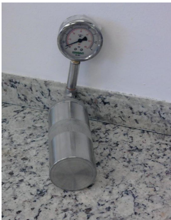
Figura 15. Fotografia ilustrando reator de aço inoxidável (autoclave) utilizado nos experimentos de pré-tratamento do bagaço de cana de açúcar.
