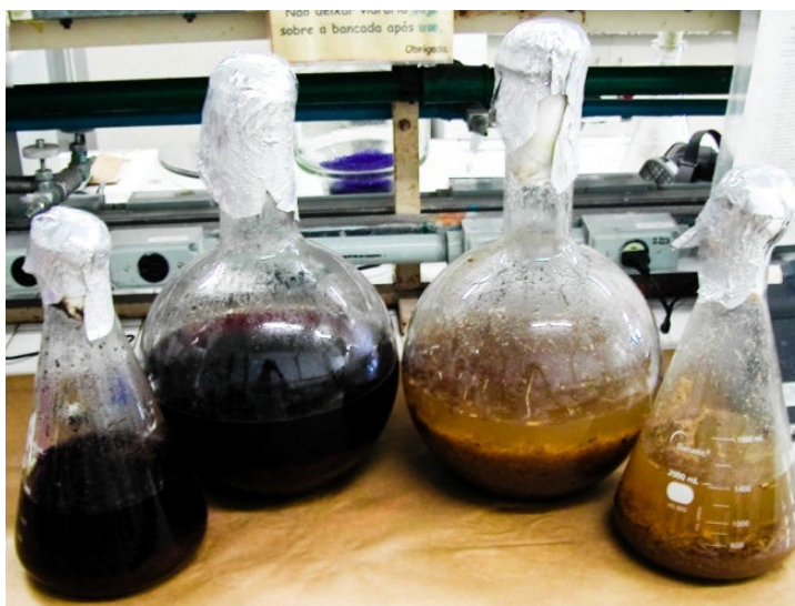
Figura 16 - Fotografia dos frascos Erlenmeyer e balão de vidro ao final da etapa de pré-tratamento (etapa de deslignificação) das amostras de BCA in natura e explodido (deslignificação com solução de NaOH).
