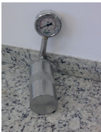
Figura 17 - Fotografia do reator cilíndrico de aço inoxidável (autoclave) utilizado nos experimentos de pré-tratamento do BCA empregando solução de \text{NH}_4\text{OH} (Silva, 2011).
