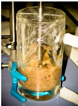
Figura 18 - Fotografia do reator utilizado nos experimentos de hidrólise enzimática na configuração SHF ( Separated Hydrolysis and Fermentation ) nas etapas 1, 2 e 3.
