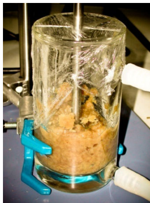
Figura 25 - Fotografia do reator utilizado nos experimentos de hidrólise enzimática da etapa 1 (volume do meio reacional 60 mL).
