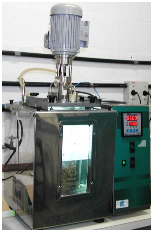
Figura 19 - Fotografia do reator utilizado nos experimentos de hidrólise enzimática na configuração SHF ( Separated Hydrolysis and Fermentation ) na etapa 4.
