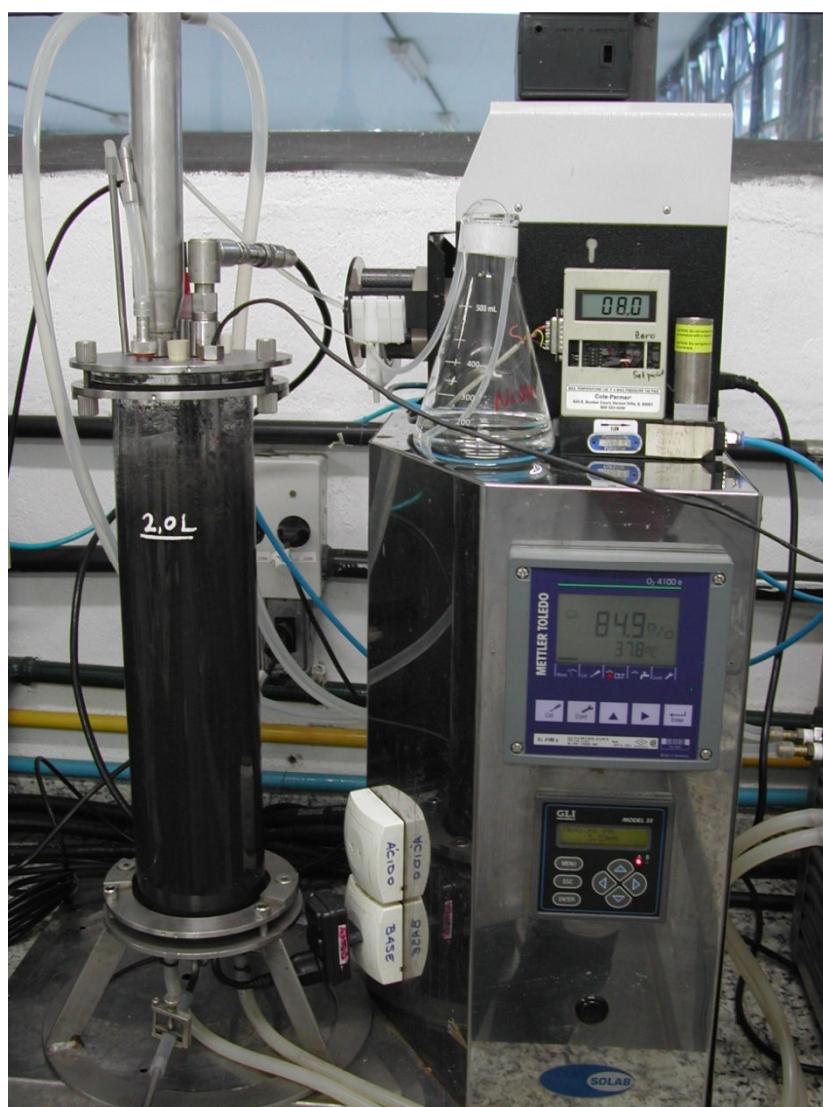
Figura 3.3. Biorreator Airlift durante ensaio de produção de ácido glucônico.
