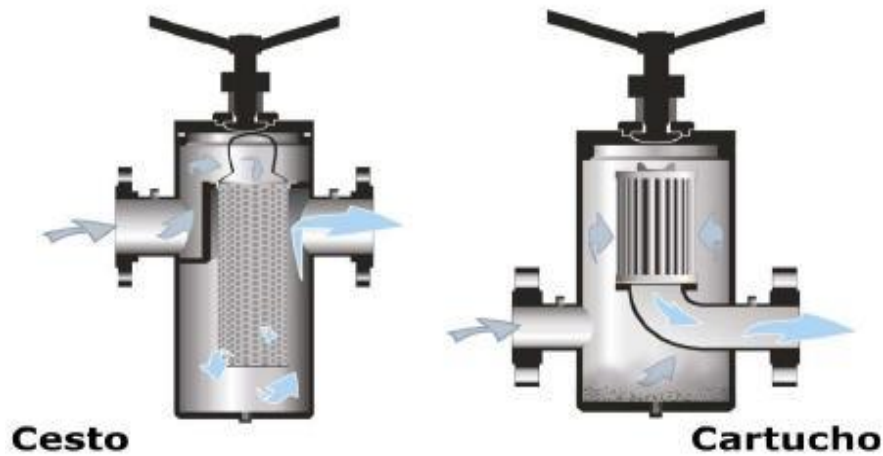
Figura 2.5: Diferença entre os filtros modelo cesto e modelo cartucho
