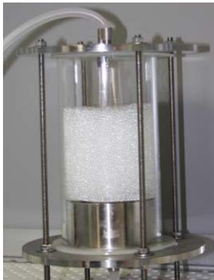
Figura 14 - Sistema de biorreator de leito fixo de 300 cm 3 .
