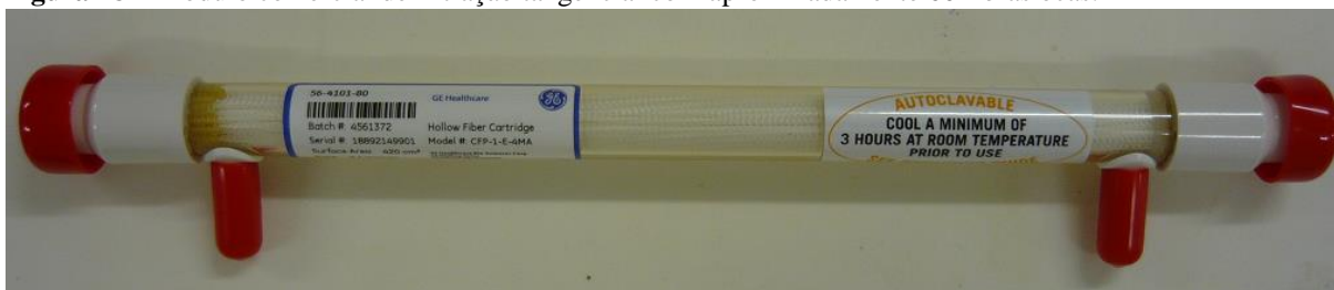
Figura 18 – Modulo comercial de filtração tangencial com aproximadamente 60 fibras ocas.
