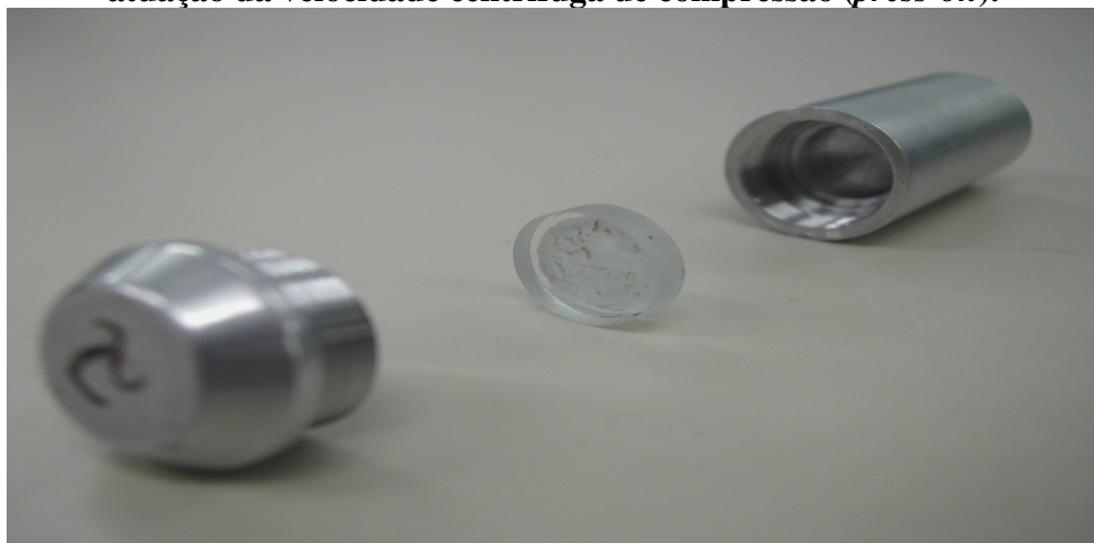
Figura 3.16.: Disco de prova e tubo de alumínio para ser colocado na centrífuga para atuação da velocidade centrífuga de compressão ( press-on ).
