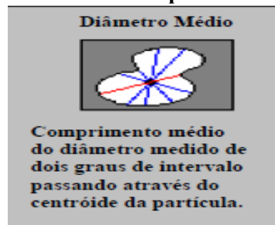
Figura 3.3.: Diâmetro médio definido pelo software Image-Pro Plus 7.0
