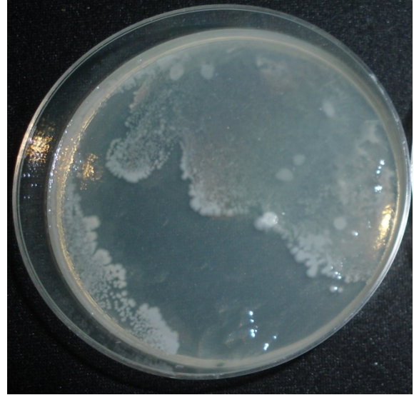
Figura 50: Placa referente ao filtro de algodão impregnado com nanopartículas de prata no tempo de cultivo de 48h (d).
