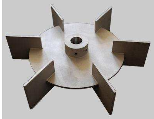
Figura 2.2 – Foto de uma turbina de seis pás planas.
