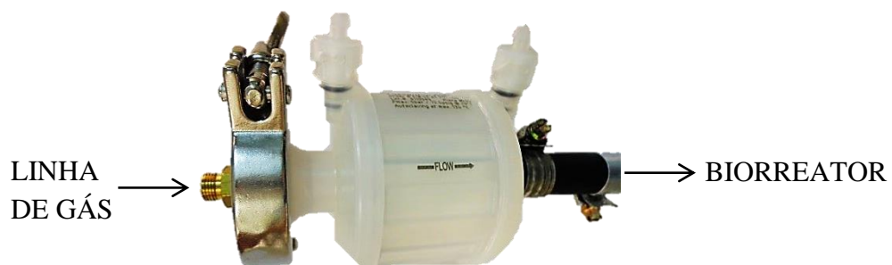
Figura 11. Sistema de filtração do gás de entrada do biorreator airlift .
