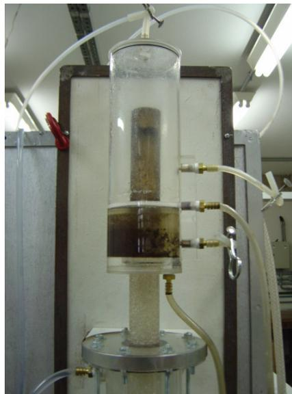
Figura 3.3 – Topo do reator (Câmara de captação de gás e dispositivo para saída do efluente).
