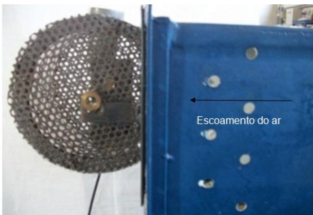
Figura 3.5: Imagem do cesto inserido no duto de escoamento de ar em vista lateral direita
