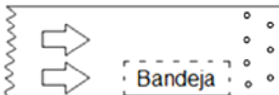
Figura 3.13: Esquema de secagem das folhas na bandeja inserida no interior do duto de escoamento de ar (vista lateral)
