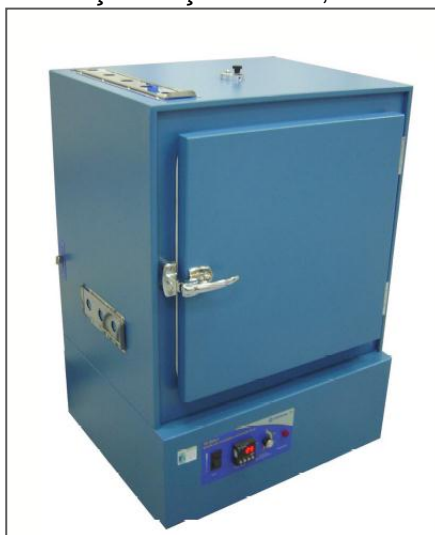
Figura 3.4 – Estufa sem circulação forçada de ar, marca Tecnal, modelo TE-394/1.
