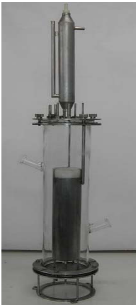
Figura 3-1 - Biorreator airlift e esquema da circulação do fluido
